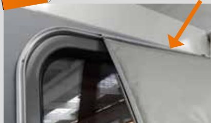
1) Faire glisser le jonc de la housse dans le rail horizontal
