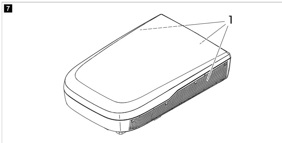
2. De temps à autre, nettoyez les carters de l'unité de toit et du caisson de distribution d'air avec un chiffon humide. Utilisez uniquement de l'eau avec un détergent doux.
