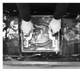
Zur Reinigung der Zwischenräume, tauchen Sie die Haube in ein mit Wasser gefülltes Gefäß und lassen den Schmutz ein wenig einweichen.
