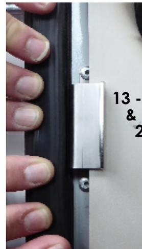
14 - Re-clipser la Garniture Beige, Remonter les Vis du Cache Noir & Repositionner le Joint
